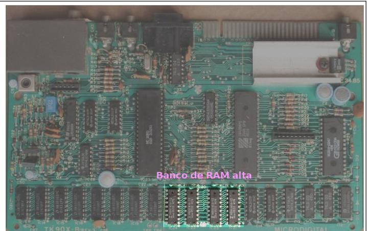
Placa do TK90X: à esquerda, em destaque, banco de RAM baixa de 16KB do TK90X, a qual não pode ser removida por estar sob controle direto do ULA; à direita, em destaque, banco de RAM alta de 32KB do TK90X, que deverá ser removida ou desabilitada antes de se conectar a TKMEM-128.
